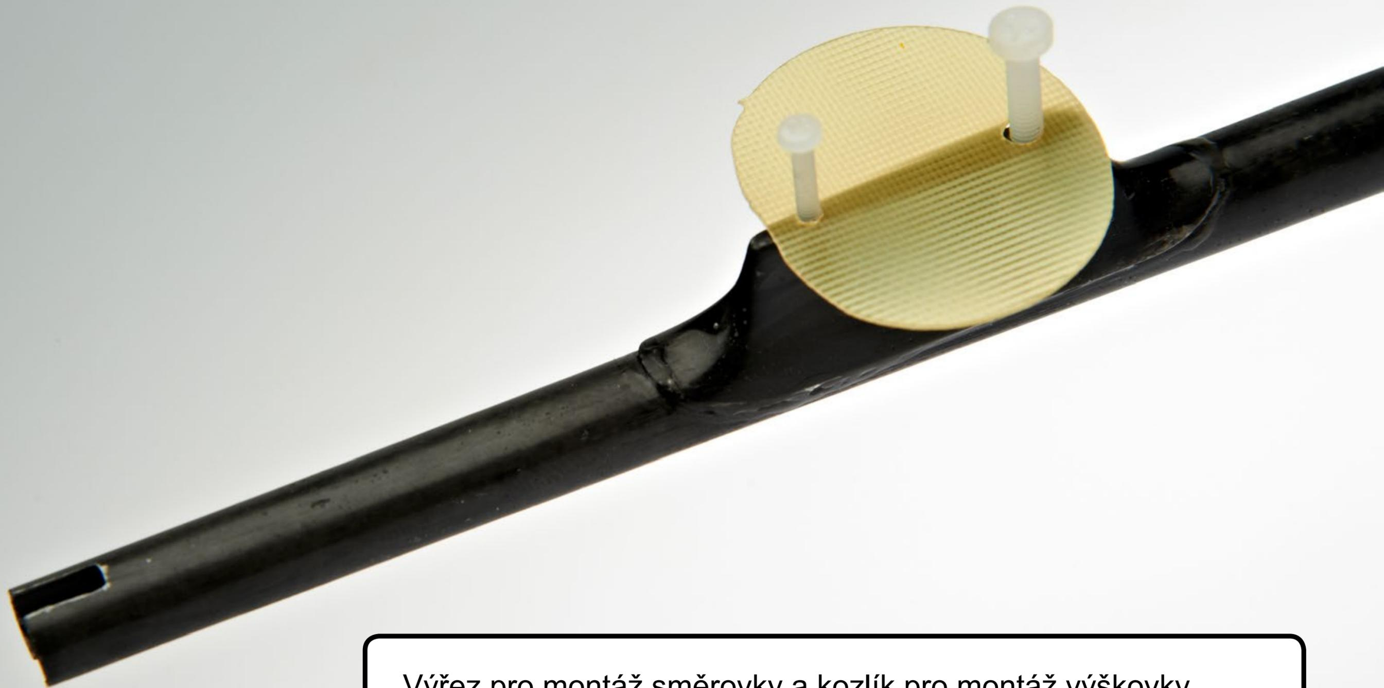
Výřez pro montáž směrovky a kozlík pro montáž výškovky.
