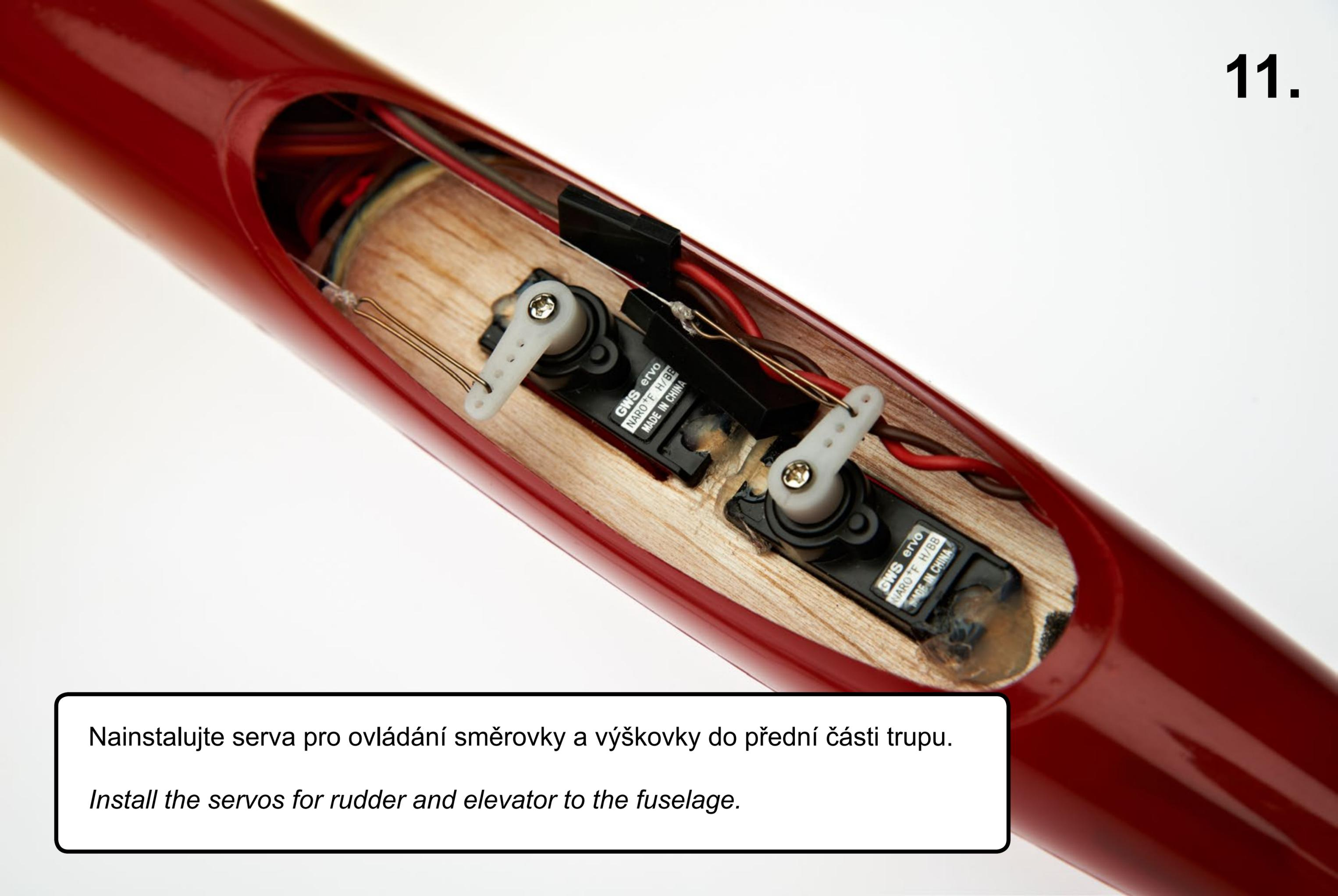
Nainstalujte serva pro ovládání směrovky a výškovky do přední části trupu.
