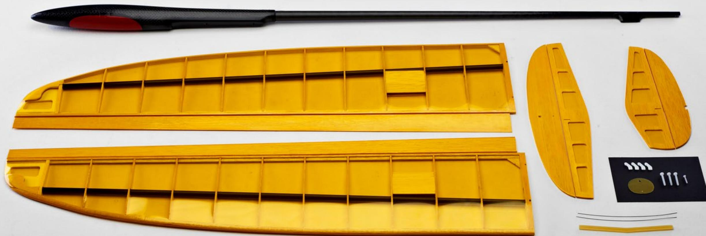
Obsah stavebnice: trup, potažené křídlo, spojku křídla, potaženou směrovku a výškovku, 2 pružiny pro směrovku a výškovku, podložku pod výškovku, 4 plastové šrouby, 4 plastové páčky a CD s návodem.
