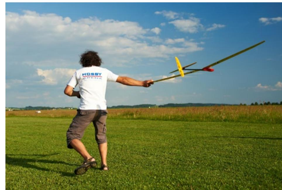
Házedlo byste měli vypustit proti větru. Vertikální úhel odhozu určuje úhel stoupání modelu.
