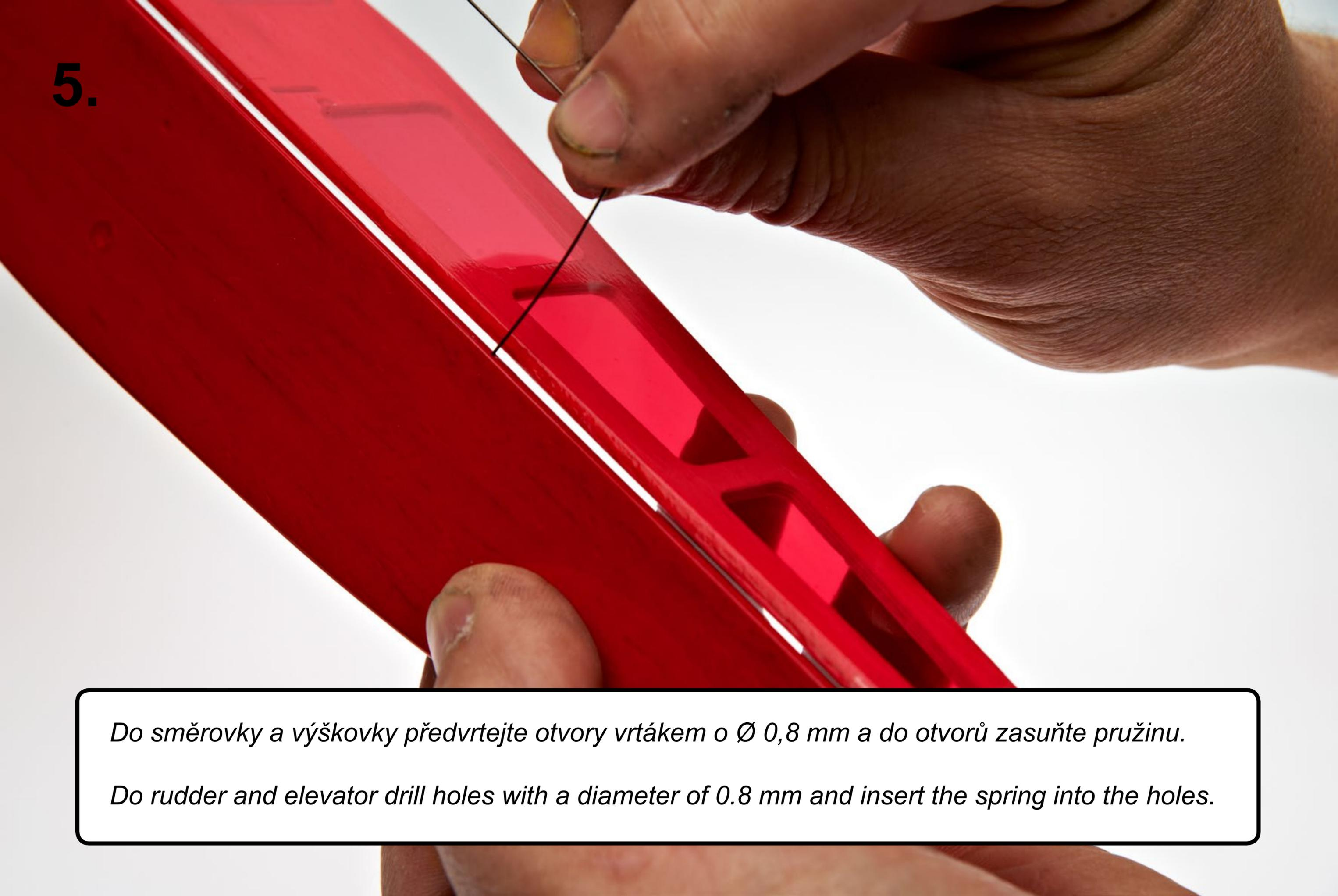
*Do směrovky a výškovky předvrtejte otvory vrtákem o  $\varnothing$  0,8 mm a do otvorů zasuňte pružinu.*
